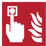
Figuur 10 Handmelder brandmeldinstallatie
